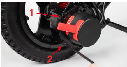
Abbildung 1: Lösen der Schrauben
