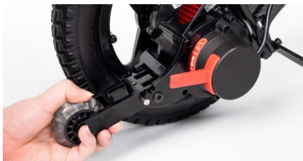
Abbildung 3: Aufsetzen des Kippschutzes
