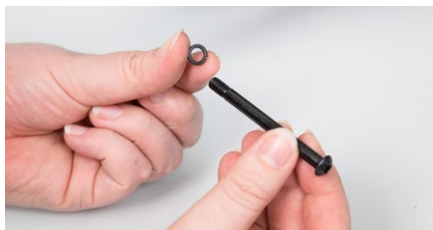
Abbildung 2: Ansetzen der Unterlegscheibe
