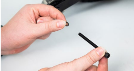
Abbildung 5: Ansetzen der Unterlegscheibe
