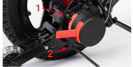
Abbildung 6: Festziehen der Schrauben
