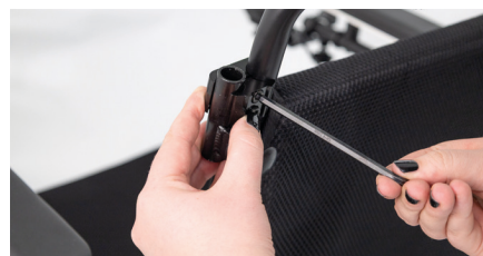
Figure 4 : Serrage du collier de fixation
