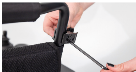
Figure 1 : serrage léger du collier de fixation
