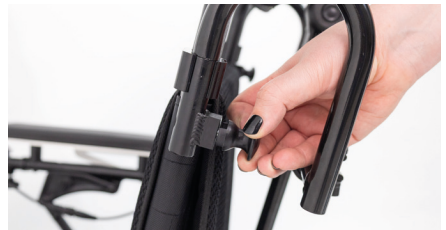
Abbildung 8: Einrasten der Kunststoffhebel
