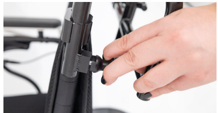
Abbildung 14: Lösen der Kunststoffhebel
