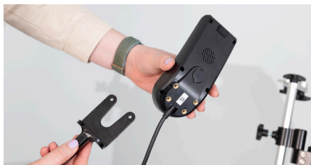
Figure 5 : dévissage de l'ancien support
