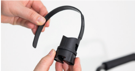
Abbildung 3: Rausziehen des Kabels
