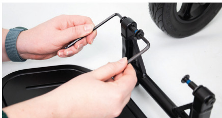
Abbildung 3: Lösen der Schrauben
