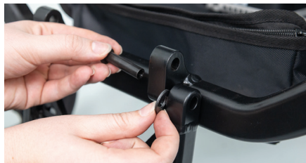
Abbildung 4: Einsetzen der Hülse und Unterlegscheibe
