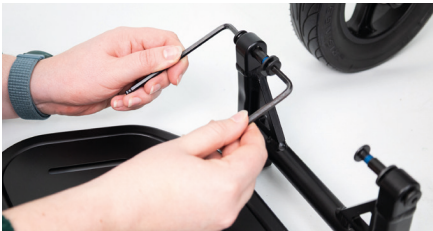
Figure 3 : Desserrage des vis
