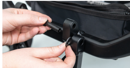
Figure 4 : Insertion de la bague et de la rondelle
