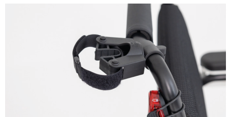
Abbildung 10: Fertig montierte Kletthalterung
