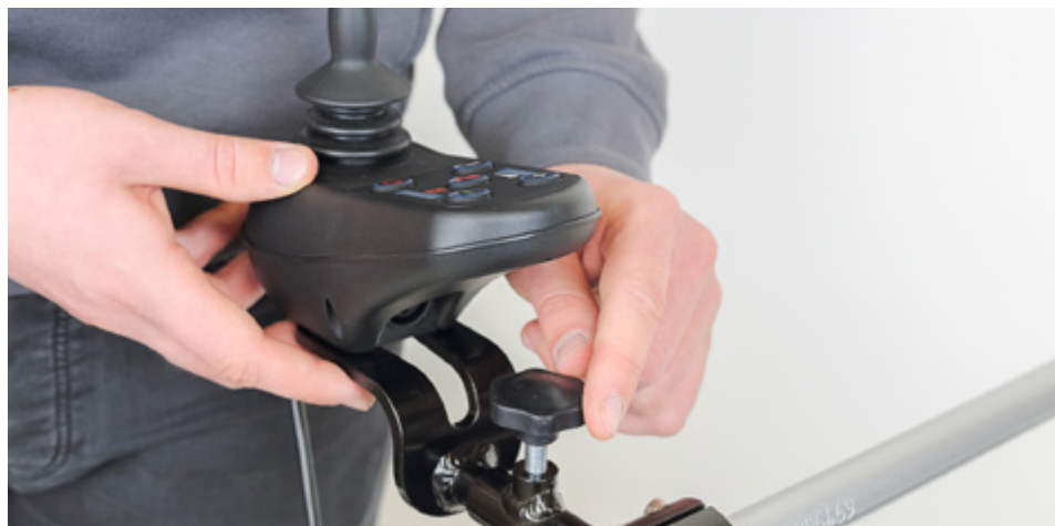
Abbildung 15: Fixieren des Bedienmoduls am Adapter
