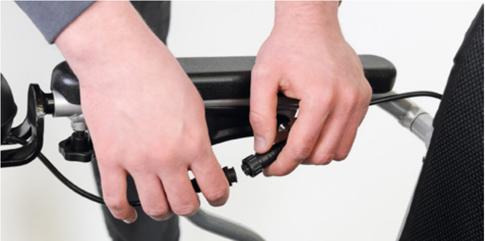
Abbildung 1: Trennen des Bedienmodulkabels von dem Anschlusskabel des Rollstuhls
