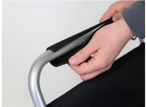
Abbildung 10: Entfernen des Schaumstoffs
