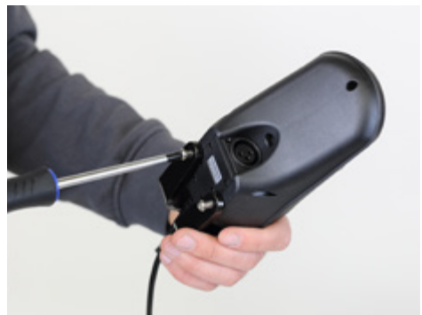
Abbildung 3: Lösen des Bedienmoduls von der Gabel
