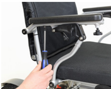
Abbildung 6: Lösen des Bedienmodulkabels von der Armlehne
