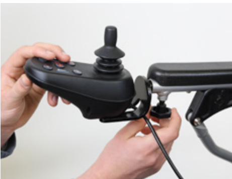
Abbildung 2: Lösen des Bedienmoduls von der Armlehne
