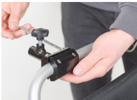
Abbildung 13: Finale Positionierung und Festschrauben des Adapters
