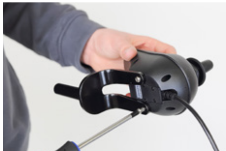
Abbildung 5: Festschrauben des Bedienmoduls an der Gabel
