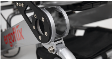
Figure 1: Retrait du support de batterie
