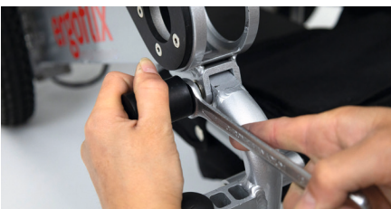
Abbildung 9: Arretieren des Adapters
