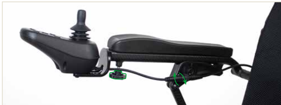
Abbildung 5: Das Bedienmodul fixieren und verbinden.
