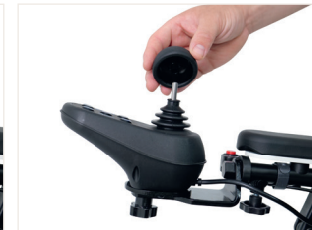
Figure 4 : Placement du nouvel embout sur la goupille métallique
