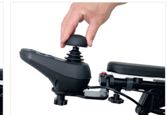
Figure 4 : Placement du nouvel embout sur la goupille métallique
