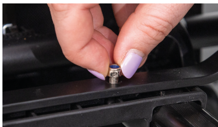
Figure 4 : Installation des écrous
