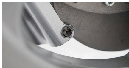
Figure 6 : Extrémité de vis qui dépasse
