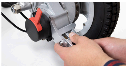
Abbildung 3: Aufsetzen des Kippschutzes
