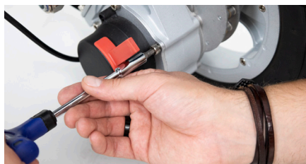
Figure 2 : Desserrer la vis supérieure
