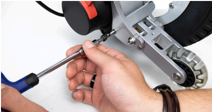
Abbildung 5: Anziehen der unteren Schraube
