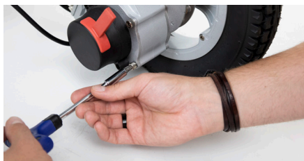
Figure 1 : Desserrer la vis inférieure
