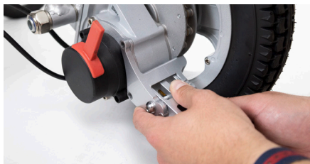
Figure 3 : Mise en place de la roulette anti-bascule
