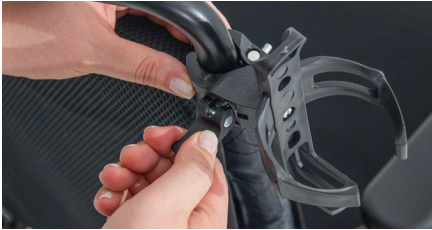
Abbildung 5: Festdrehen des Flaschenhalters
