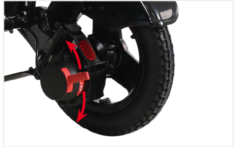
Abbildung 14: Aktivieren oder Deaktivieren der Feststellbremsen
