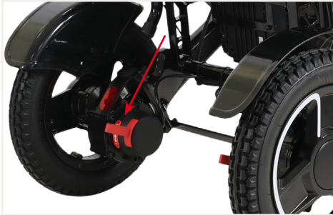
Abbildung 13: Position der Feststellbremsen
