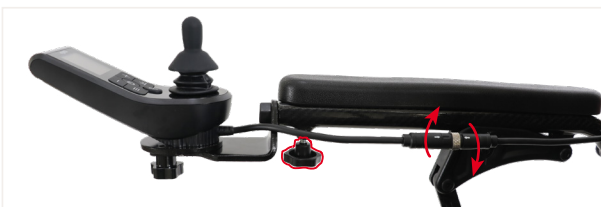
Abbildung 6: Das Bedienmodul fixieren und verbinden
