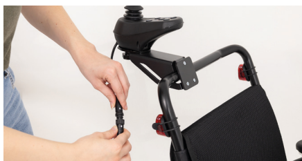
Figure 7 : Connexion du câble
