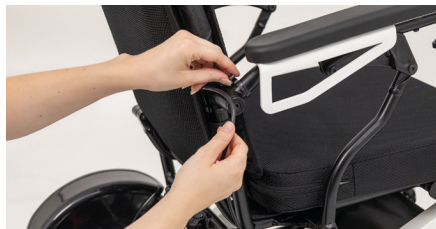
Figure 6 : Passage du câble
