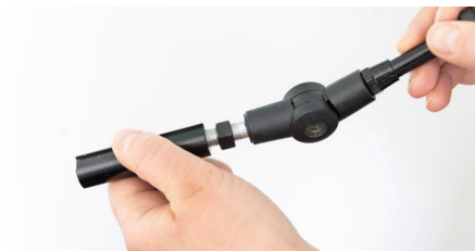
Figure 1 : Vissage du tube sur le filetage du rétroviseur
