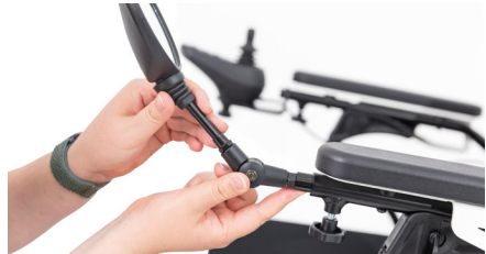
Figure 5 : Desserrage et réglage du joint de la vis à six pans creux
