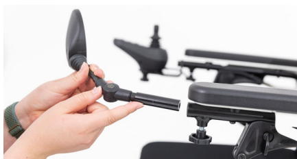
Figure 3 : Insertion du rétroviseur dans le tube de l'accoudoir
