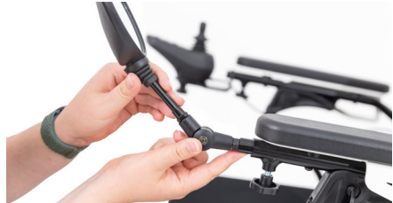
Abbildung 5: Lösen und Verstellen am Gelenk der Innensechskantschraube
