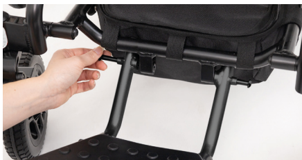
Figure 5 : Mise en place des vis écrous
