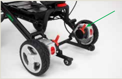
Abbildung 10: Position der Feststellbremsen
