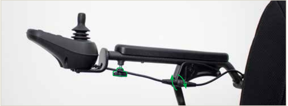
Abbildung 5: Das Bedienmodul fixieren und verbinden.
