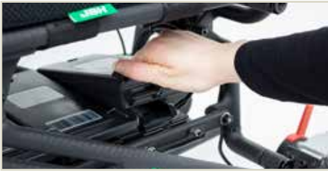
Abbildung 7: Den Akku wechseln
