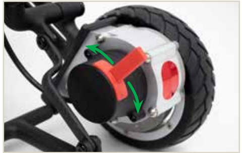
Abbildung 11: Aktivieren oder Deaktivieren der Feststellbremsen
