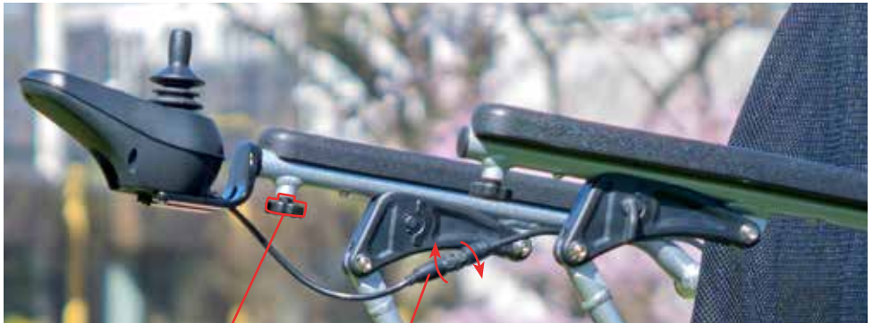
Abbildung 5: Das Bedienmodul fixieren und verbinden
